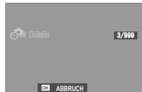
**!** Die Intervallaufnahme kann weder bei Langzeitbelichtung **B** (Bulb) noch bei Mehrfachbelichtung verwendet werden. Im Serienaufnahmemodus wird bei jeder Auslösung nur ein Bild aufgenommen.
