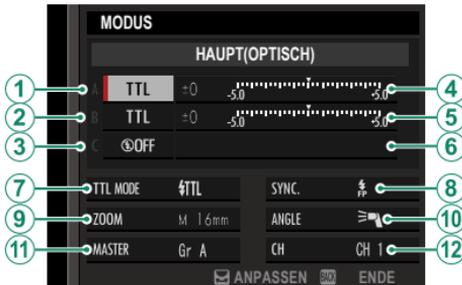
Das Master-Blitzgerät und die ferngesteuerten Slave-Blitzgeräte können in bis zu drei Gruppen eingeteilt werden (A, B und C). Blitzmodus und Blitzleistung lassen sich für jede Gruppe getrennt einstellen. Vier Kanäle stehen für die Kommunikation zwischen den Geräten zur Verfügung; unterschiedliche Kanäle lassen sich für verschiedene Gerätekonfigurationen nutzen, oder um gegenseitige Störungen zu verhindern, wenn mehrere Systeme in räumlicher Nähe betrieben werden.
